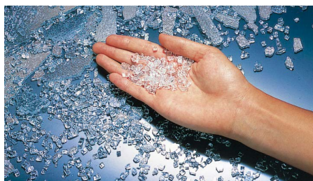
熱処理ガラスの割れた場合
