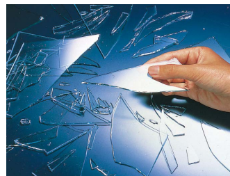
普通の板ガラスの割れた場合
