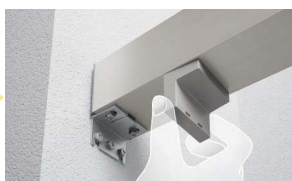
ブラケットカバー裏に適量のシーリングを充填し、カバーを取付けます。
