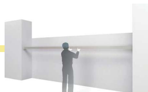
あらかじめ部品(横棧キャップ、横棧ブラケット)を取付けておいた横棧をコーチねじに乗せて仮置き。
