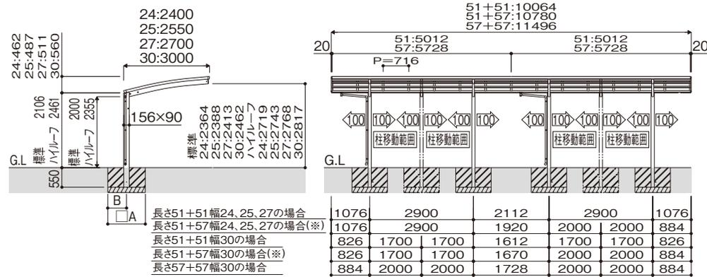
※長さ57+51幅24, 25, 27の場合と長さ57+51幅30の場合の柱間の距離は、上図と前後逆の距離になります。
