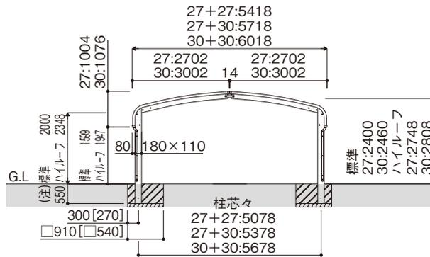
(注)27+30:幅30側の柱を38mm深く埋込む
