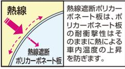
熱線遮断ポリカーボネート板は、ポリカーボネート板の耐衝撃性はそのままだに熱による車内温度の上昇を防ぎます。
