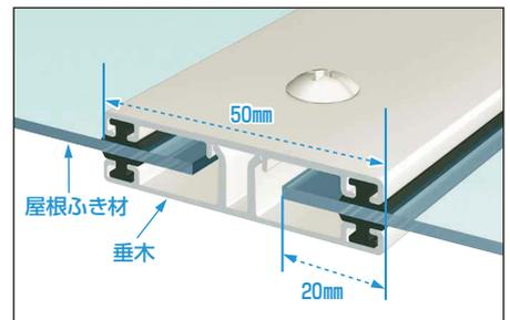
垂木・屋根ふき材の押さえ幅を50mm、のみ込み幅を20mmに設定。屋根ふき材の抜け強度を十分に確保しています。
