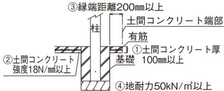
※左図の基礎条件下では、各寸法図中のA×B寸法は、表中の寸法にて施工していただけます。
