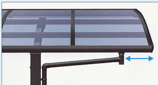
側枠から雨樋までの寸法が短いため、水勾配による後枠内の水溜りの心配がありません。
