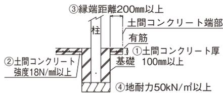
※左図の基礎条件下では、各寸法図中のA・B寸法は、表中の寸法にて施工していただけます。また、その寸法はサイドパネルを取付けても変わりません。
