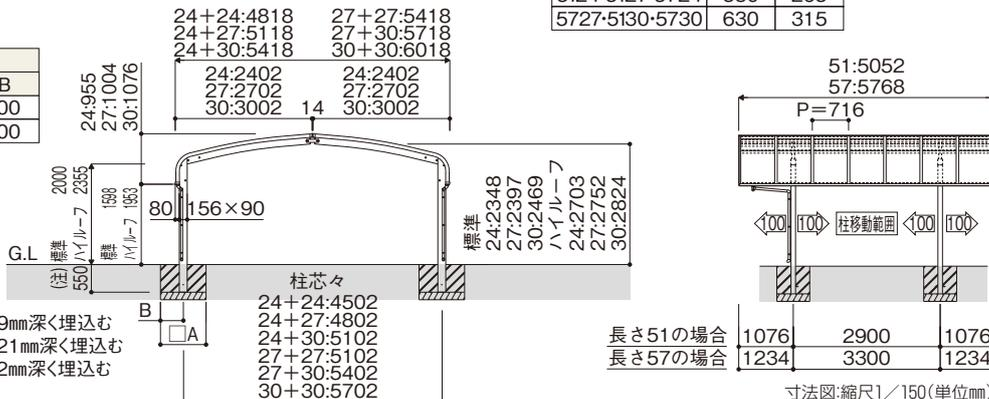
(注) 24+27:幅27側の柱を49mm深く埋込む
