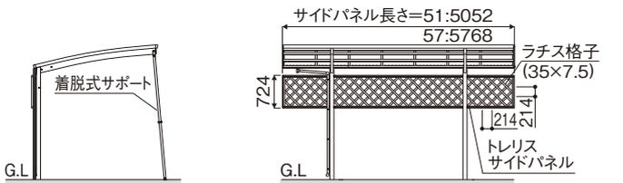
※基礎寸法については、右ページのサイドパネルと同じ条件となります。 寸法図:縮尺1/150(単位mm)
